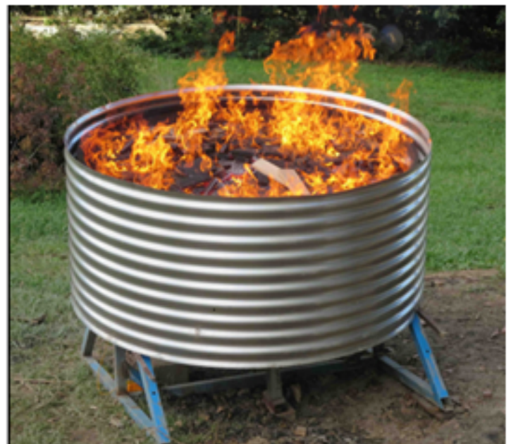
Forno de pirólise lenta para produção de biochar baseado no princípio da cortina de fogo ( https://wiki.opensourceecology.org ).
